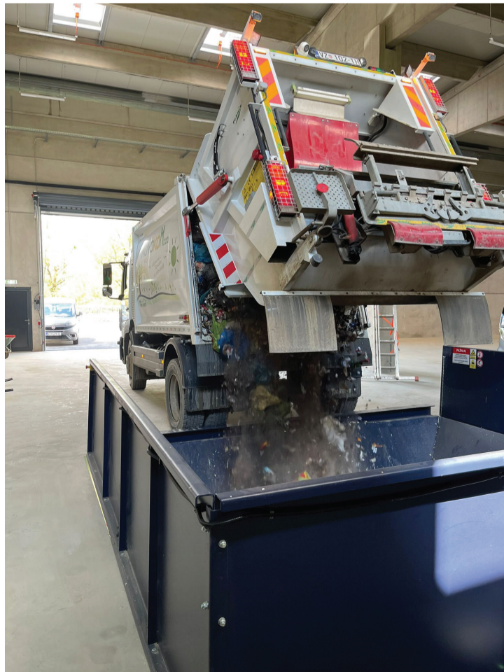
Posebna pažnja posvećena je zaštiti okoliša. Sustav transporta otpada u zatvorenim rolo kontejnerima sprječava rasipanje otpada, širenje prašine, neugodnih mirisa i buke
